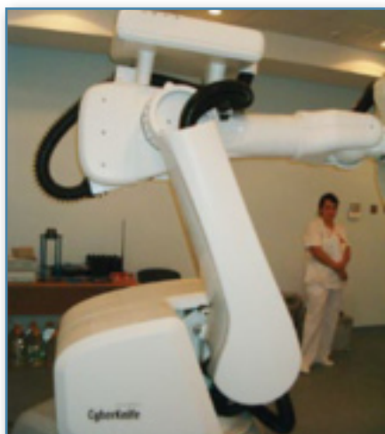
Система CyberKnife з компактним лінійним прискорювачем
