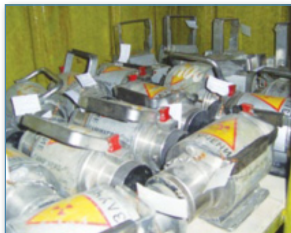
Гамма дефектоскопи типу Гаммарід-192/120 на зберіганні на ПЗРО ОДМСК
