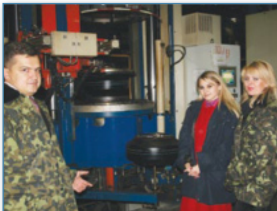
Рентгенівська установка для дефектоскопії шин ЗАТ «Росава»
