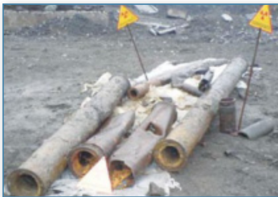
Металеві труби, забруднені природними радіонуклідами (ВАТ «Алчевський металургійний комбінат»)
