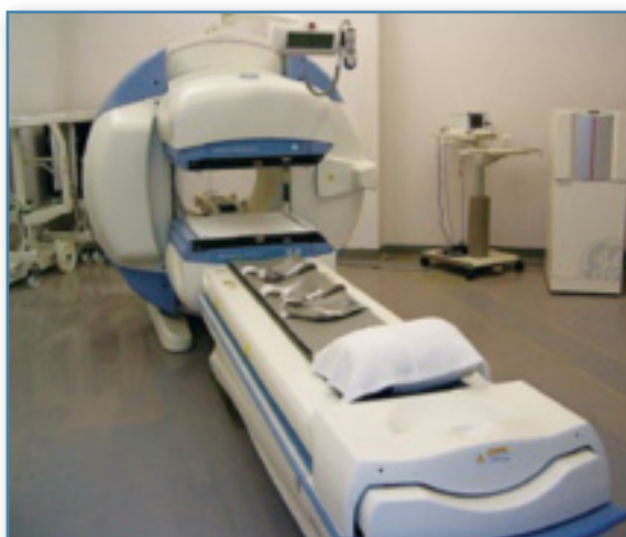
Гамма-камера Infinia Hawkeye з інтегрованою комп'ютерною томографією
