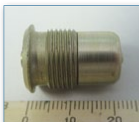
Виявлена капсула з плутонієм, що використовується для живлення сигналізатора диму
