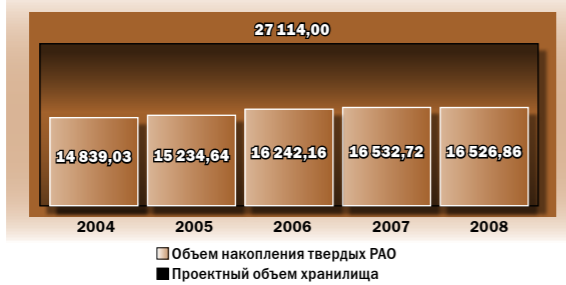
Объемы накоплений твердых РАО в хранилищах ОП ЮУАЭС (м³)
