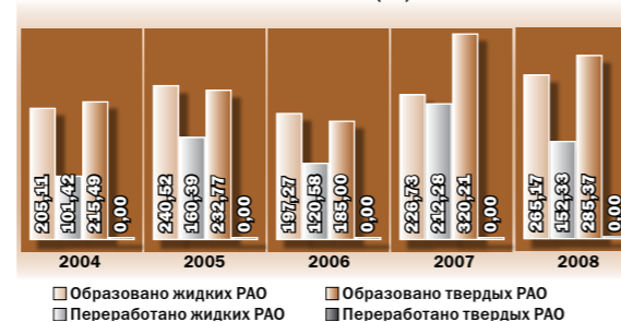
Объемы накоплений твердых РАО в хранилищах ОП ХАЭС (м³)
