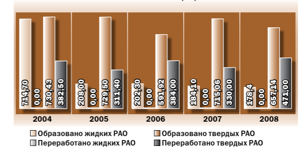
Динамика образования и переработки РАО на ОП ЮАЭС (м³)
