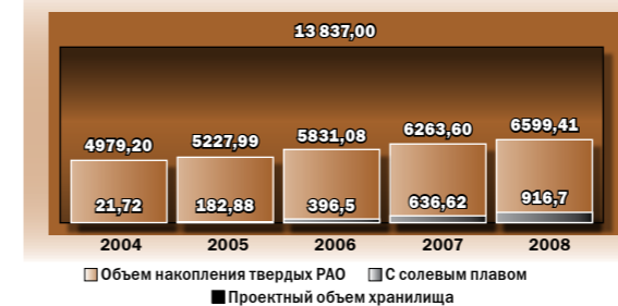
Объемы накоплений твердых РАО в хранилищах ОП РАЭС (м³)
