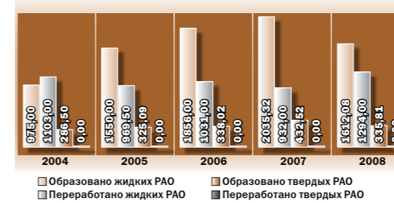
Динамика образования и переработки РАО на ОП РАЭС (м³)
