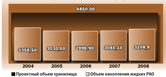
Объемы накоплений жидких РАО в хранилищах ОП ЮУАЭС (м³)
