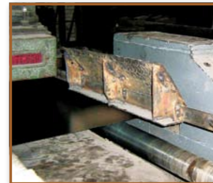
Использование ИИИ на прокатном стане для контроля толщины проката
