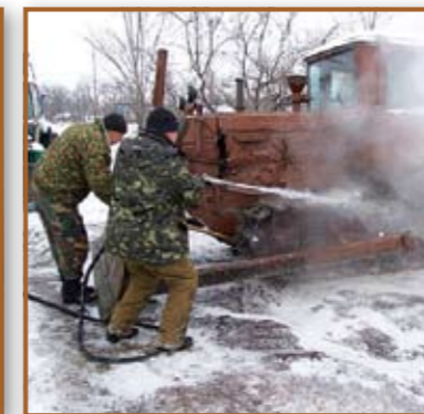
Дезактивація техніки після виконання робіт
