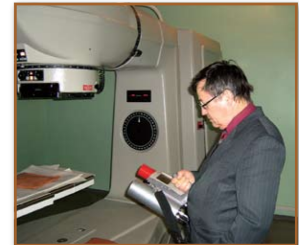
Інспектор перевіряє наявність ДІВ у обладнанні
