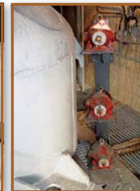
Контроль рівня заповнення бункера
