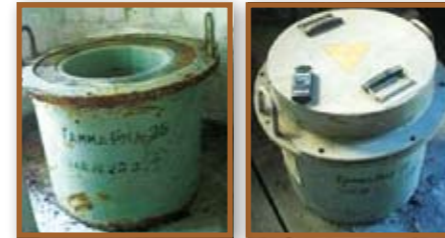
Зовнішні упаковки з транспортно-пакувальних комплектів УКТ-Д11 від гамма-дефектоскопів типу Гаммарид-25 і Гаммарид-20, які були виявлені при інспектуванні ТОВ «Рубіжанський Краситель».
