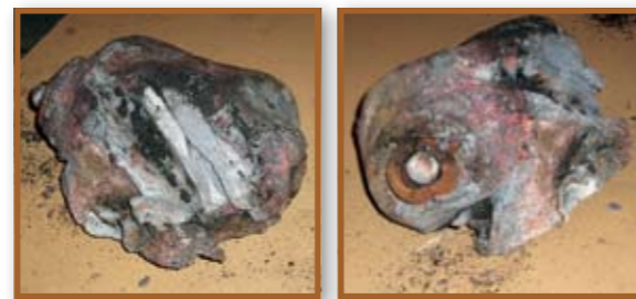
Блок джерела після падіння у стовбур
