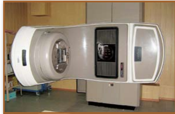
Прискорювач електронів Сіпаз для променевої терапії
