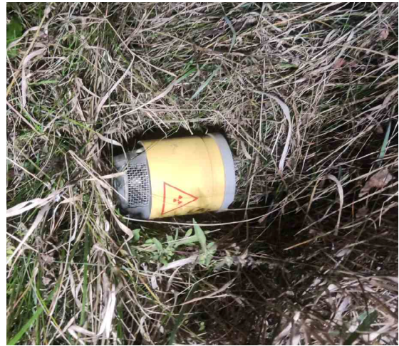
Фото 19 – Виявлений на території смт. Покотилівка Харківської області пожежосповіщувач РИД-1 1979 року
