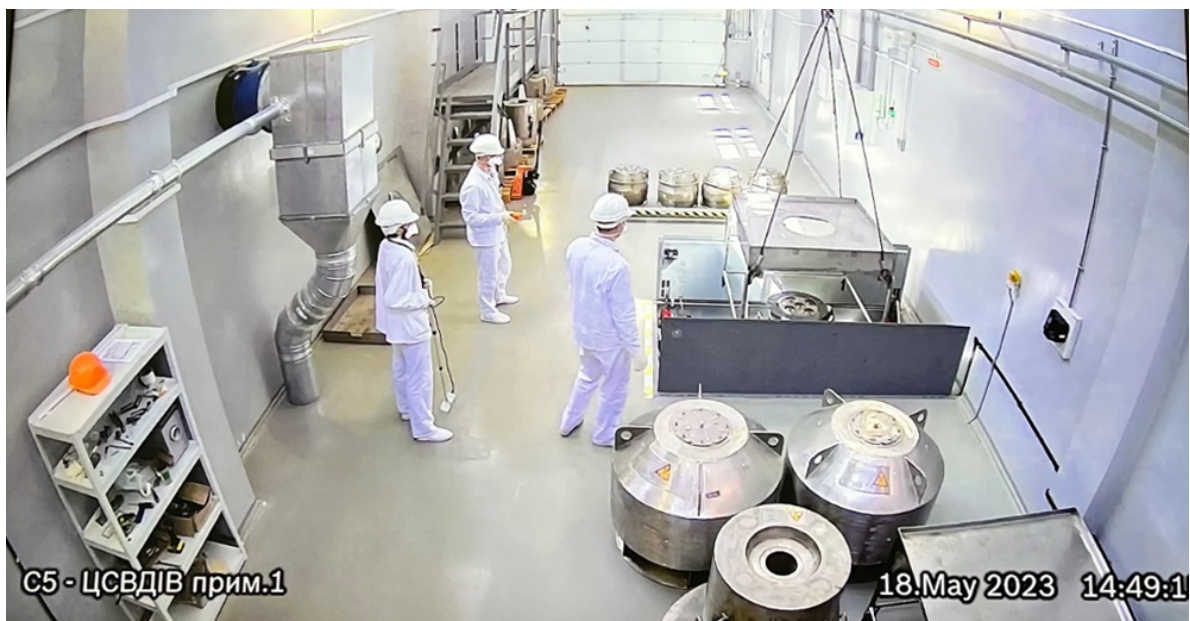
Фото 9 – «Гарячі» випробування технологічного обладнання ЦСВДІВ з використанням ВДІВ типів «ИБН-7» і «ИБН-9»
