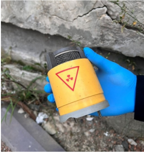
Фото 19 – Виявлений на території смт. Покотилівка Харківської області пожежосповіщувач РИД-1 1979 року
