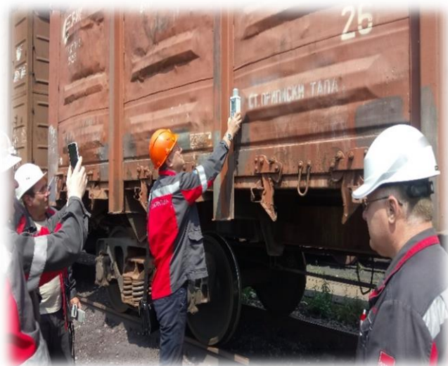
Проведення радіологічного обстеження затриманого вантажу з металобрухтом у ПАТ «ЗАПОРІЖСТАЛЬ»
