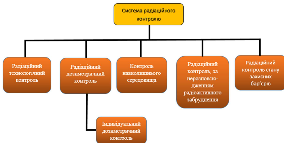
Рис. 2.12 Загальний вигляд системи радіаційного контролю на ЗАЕС
