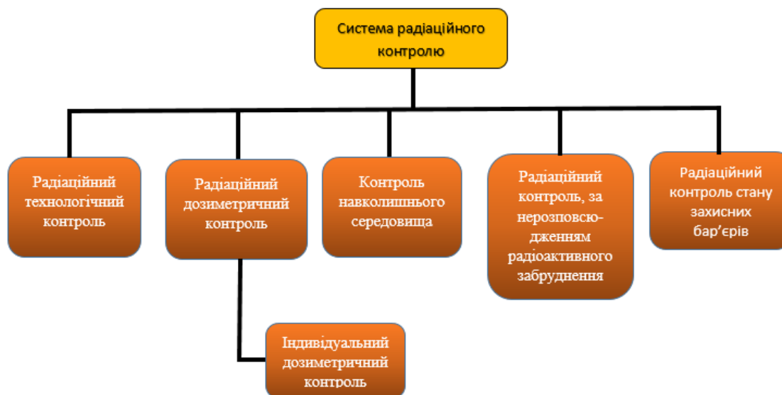
Рис. 6.1 – Загальний вигляд системи радіаційного контролю на ЗАЕС
