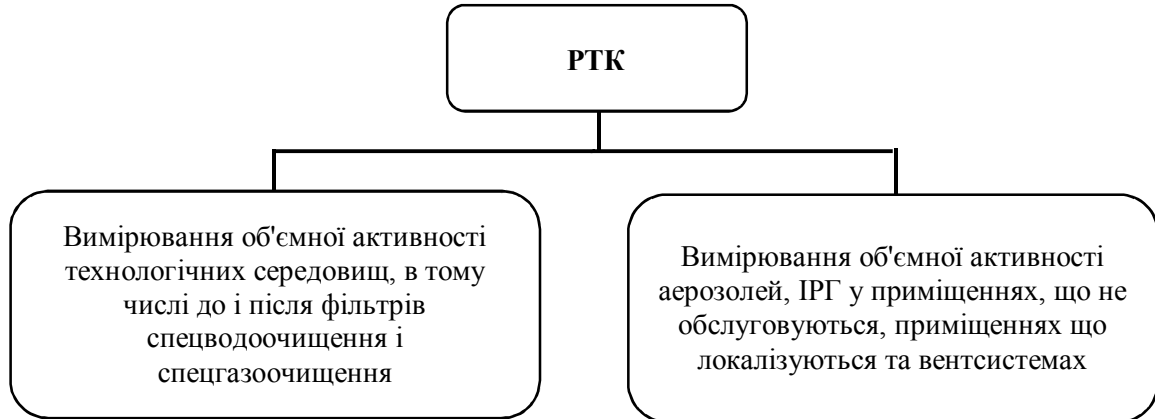
Рис. 6.2 – Загальний вигляд підсистеми радіаційного технологічного контролю на ЗАЕС
