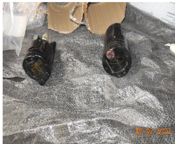
Фото 15 – Авіаційні компаси КИ-11 з ^{226}\text{Ra}
